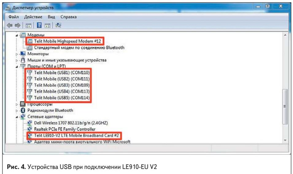
Рис. 4. Устройства USB при подключении LE910-EU V2
