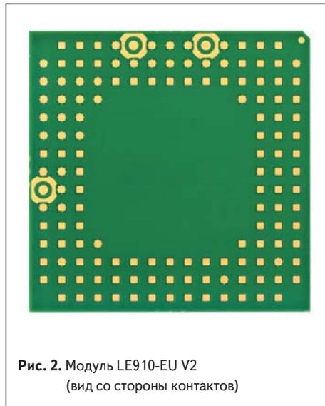
Рис. 2. Модуль LE910-EU V2 (вид со стороны контактов)
